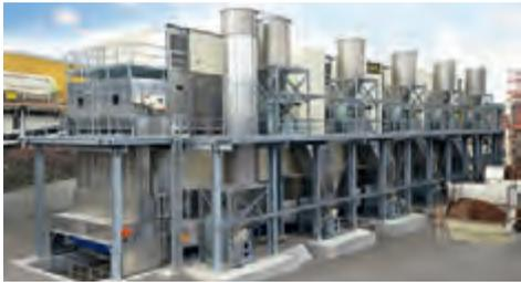
带热风循环系统的低温带式干燥机BTU型
