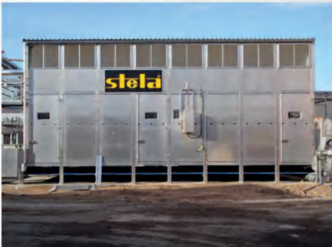
项目地: Stora Enso, 俄罗斯 型号: BT 1/6200-12 安装年份: 2008 干燥物料: 木屑 出料能力: 约3.6吨/小时 降水区间: 50%-10%含水率
