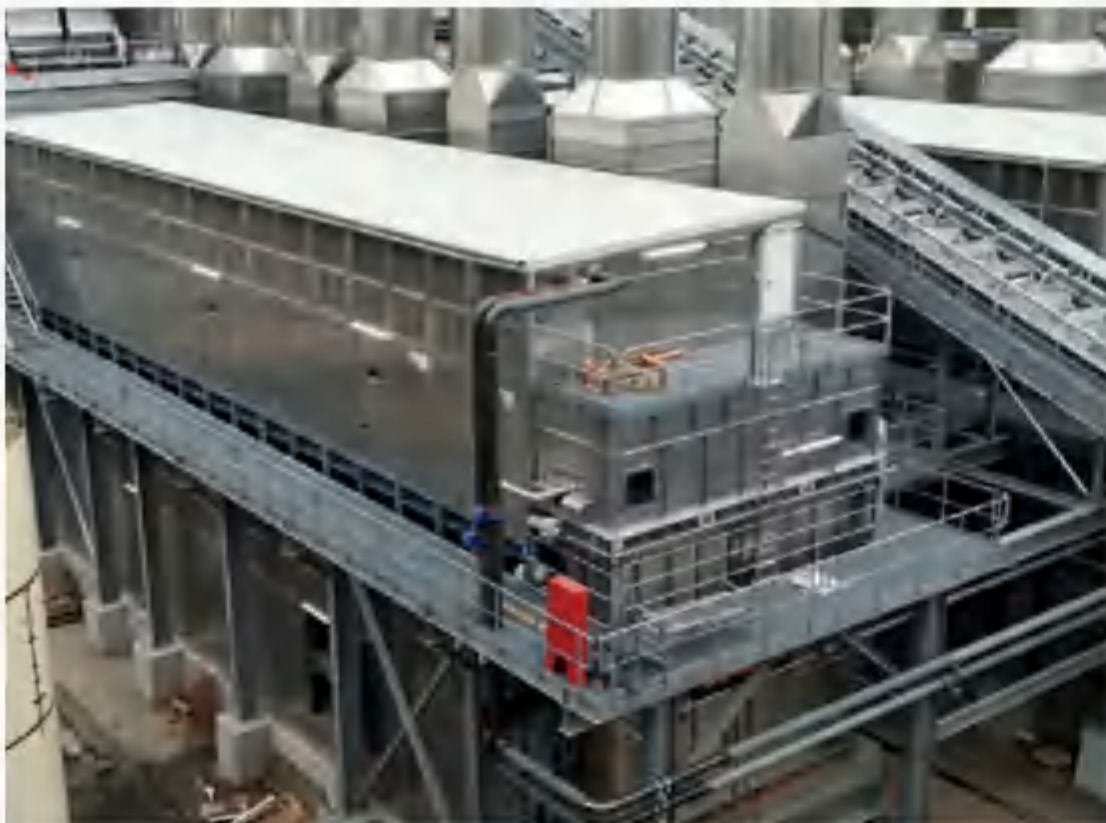
项目地: Kronospan Luxembourg S.A., 卢森堡 型号: 2xBTU 2/6200-57-16/6 安装年份: 2018 干燥物料: OSB定向刨花板 出料能力: 约2x30.6吨/小时 降水区间: 100%-2%绝对含水率
