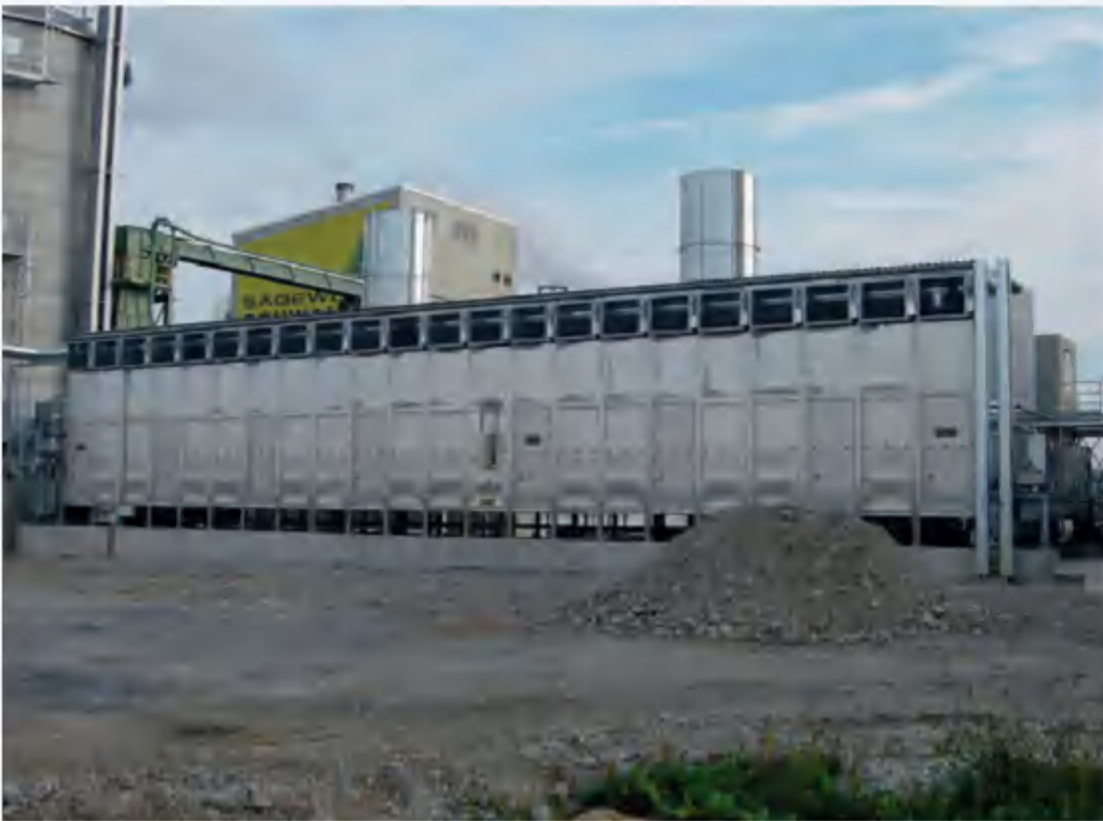
项目地: Sägewerk Schwaiger 德国 型号: BT 1/6200-33 安装年份: 2006 干燥物料: 木屑 出料能力: 约10.5吨/小时 降水区间: 50%-10%含水率
