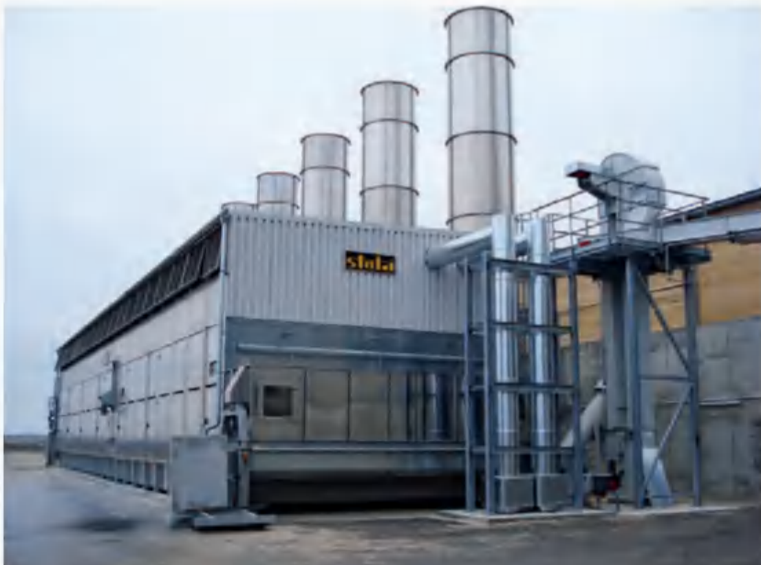
项目地: Pelletproduktion Sachsen-Anhalt Süd 德国 型号: BT 1/6200-30 安装年份: 2008 干燥物料: 木屑 出料能力: 约9.5吨/小时 降水区间: 50%-10%含水率
