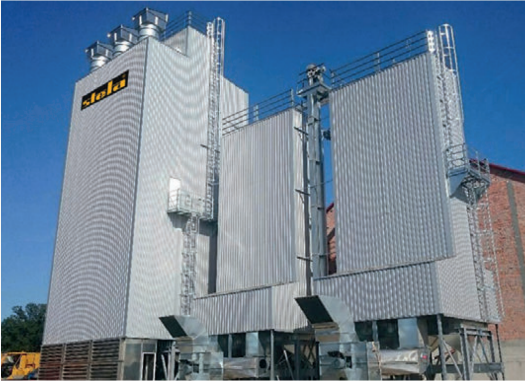
Budyn 捷克, Bukowiec 型号: MDB-XN 3/15-SB + 安装年份: 2015年 干燥物料: 玉米 干燥能力: 51.0吨/小时 降水区间: 35%-15%
