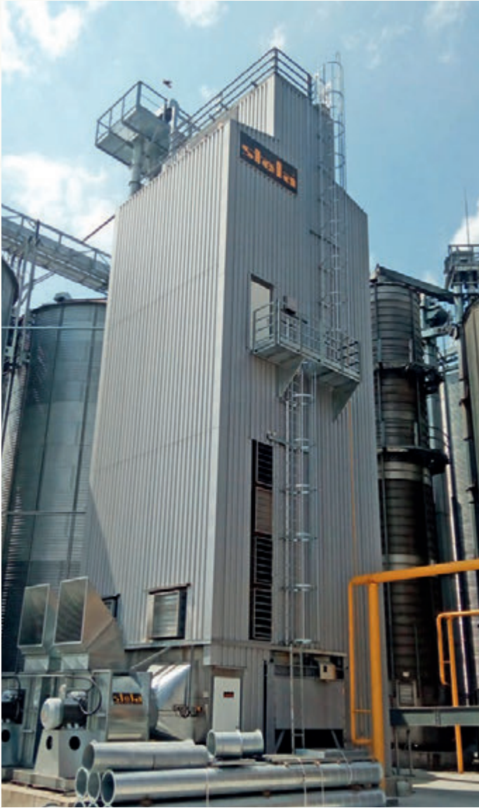
Agricultural farm "Diedov" 乌克兰, Kirovograd region 型号: MDB-XN 2/12-S 安装年份: 2017年 干燥物料: 玉米, 小麦 干燥能力: 玉米: 34.0吨/小时, 降水区间: 25%-15% 小麦: 66.5吨/小时, 降水区间: 19%-15%
