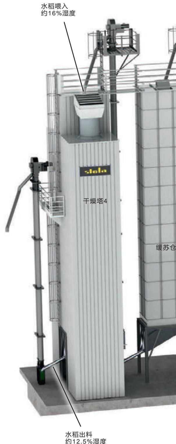
移动循环批次式干燥机MUF型通过广口喂料斗和重型提升机喂料。热风仓(1)和干燥机的外壳之间的空隙被待干燥谷物(2)完全填充。启动干燥机后，所有电机例如提升机(循环系统)，径流风机和燃烧器按照设定顺序依次启动。通过加热风机的热风被强排入内部热风仓(1)，并流经干燥仓(2)的待干燥谷物。内置减压双坡顶风管(4)确保整体物料受力均匀分布。卸粮装置(5)间断性收集干燥谷物后通过提升机(6)输送谷物到干燥仓上部。在上面的不通风区域作为物料暂存和缓苏区("缓苏过程")。MUF110型除了干燥仓上部的暂存仓之外还有缓苏仓，干燥谷物可在此无通风暂存缓苏。谷物在干燥机底部通过卸粮辊(5)卸粮并向上提升。MUF110型的卸粮辊按照长度不同分段，由计算机在不同的时间段内控制运转，确保谷物均匀混合并分配到不同的区域。
