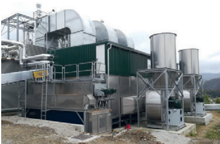
用户：Biogastur S.A. 项目地：西班牙 型号：BTU 1/6200-15 物料：橄榄果渣 干燥能力：3.3 吨/小时，降水72%-40% MC
