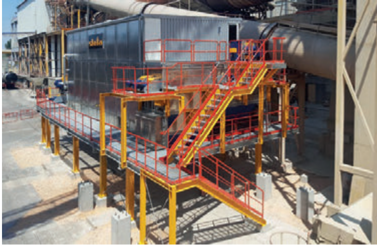
用户：Cimpor - Indústria de Cimentos, SA 项目地：葡萄牙 型号：BT 1/6200-12 物料：RDF (垃圾替代燃料) 干燥能力：7.0 吨/小时，降水40%-15% MC
