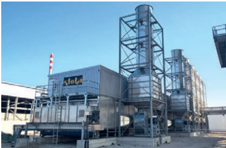
用户：Enterra spa 项目地：意大利 干燥1线： 型号：BT 1/6200-31.5 物料：橄榄果渣 干燥能力：19.5 吨/小时，降水55%-38% MC 干燥2线： 型号：BT 1/6200-9 物料：橄榄果渣 干燥能力：4.0 吨/小时，降水38%-15% MC
